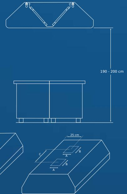
Hochwertige Deckenhauben für die professionelle Gastronomie. Monoblock-Konstruktion aus Edelstahl AISI 430 mit Scotch-Brite-Satinierung. Verschweißte Ausführung mit Neonbeleuchtung und Flamschutzfiltern (40x40 cm) aus Edelstahl. Leichte Reinigung durch umlaufende Auffangrinne für Fett und Kondenswasser. Mit integriertem Fettablasshahn.
