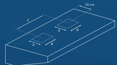
Hochwertige Basic Wandabzugshauben für die professionelle Gastronomie. Monoblock-Konstruktion aus Edelstahl AISI 430 mit Scotch-Brite-Satinierung. Verschweißte Ausführung mit Neonbeleuchtung und Flammenschutzfiltern aus Edelstahl (40x40 cm). Leichte Reinigung durch umlaufende Auffangrinne für Fett und Kondenswasser. Mit integriertem Fettablasshahn.
